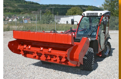
POLARIS 2450 hydraulisch verstellbare Einlaufklappe
