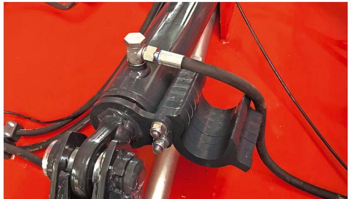
Die Höhenverstellung erfolgt über 3 Hydraulikzylinder, die jeweils an den Seitensegmenten und dem Mittelsegment befestigt sind.
