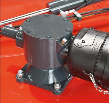
Rotorgetriebe - mit Entlüftung
