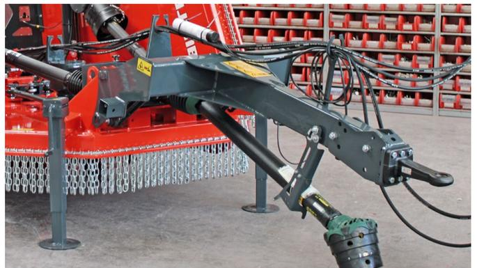
Die Deichsel kann je nach Wunsch oberhalb oder unterhalb der Gelenkwelle montiert werden.
