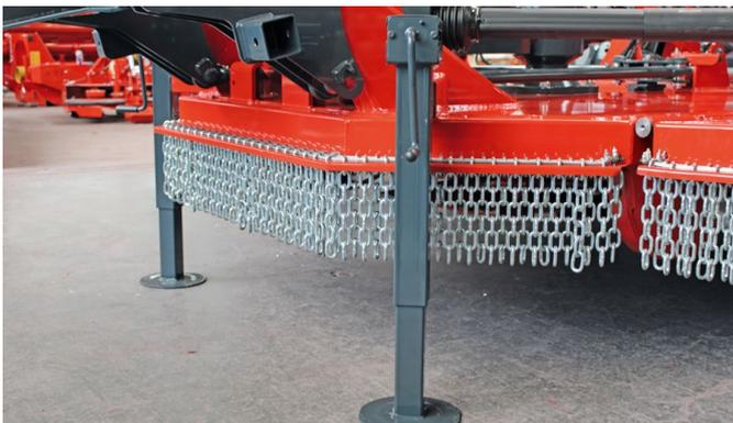
Die beiden robusten Stützfüße, welche am Mittelsegment befestigt sind, werden während des Arbeitseinsatzes an der Deichsel mitgeführt.
