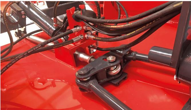
Die Neigungseinstellung wird über die Längenveränderung der Zugstange vorgenommen, sie verbindet das Fahrwerk und die Deichsel.
